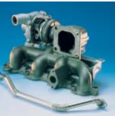
Duratorq DI: Die Turbolader sitzen dicht am Motor – für ein gutes Ansprechverhalten.
