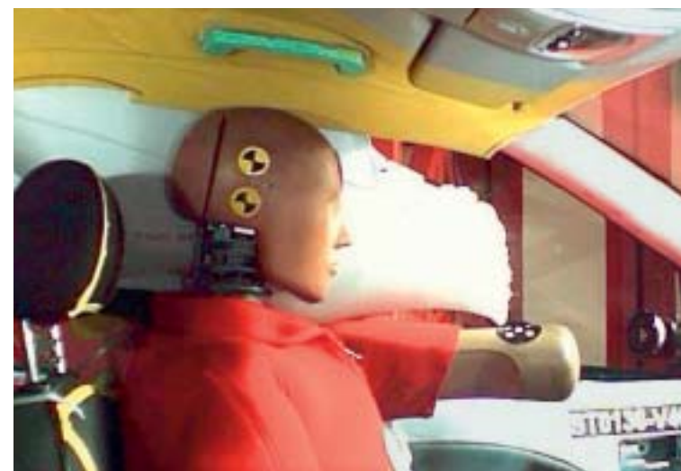
Beim Seitenaufprall verhindert ein Fenster-Airbag über die Länge der Fahrgastzelle schwere Kopfverletzungen.
