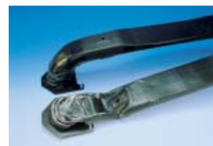
Stahl-Querträger: Kann durch vordefinierte Deformation die Aufprallenergie bis zu einem Tempo von 15 km/h aufnehmen.
