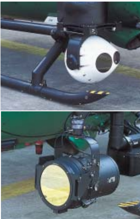
Gerüstet für die Nacht: Video-/Wärmebildkamera (oben), Suchscheinwerfer (unten) und Nachtsichtgeräte an den Pilotenhelmen.
